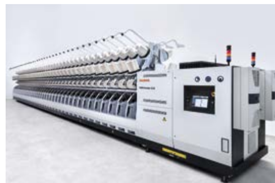
CableCorder CC5 para la fabricación de cordón de neumáticos de alta calidad.
