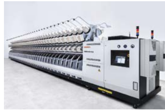
用于高质轮胎帘子线生产的CableCorder轮胎帘子线直捻机CC5。
