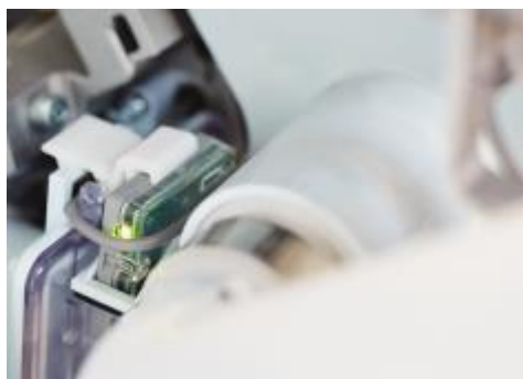
Ahorrar recursos de hilo con el sensor del hilo superior
